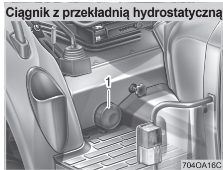
(1) Filtr oleju przekładni hydrostatycznej
