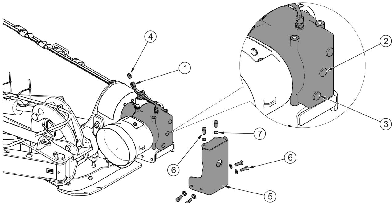
**РИСУНОК 5.6 ПРОВЕРКА И ЗАМЕНА МАСЛА В УГЛОВОЙ ПЕРЕДАЧЕ**
