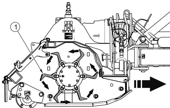
**РИСУНОК 4.1 Соответствие оборотов режущего аппарата с направлением**
