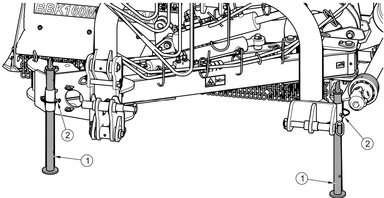
**РИСУНОК 1.3 Правильное блокирование косилки в ходе погрузки при помощи стояночной опоры**
