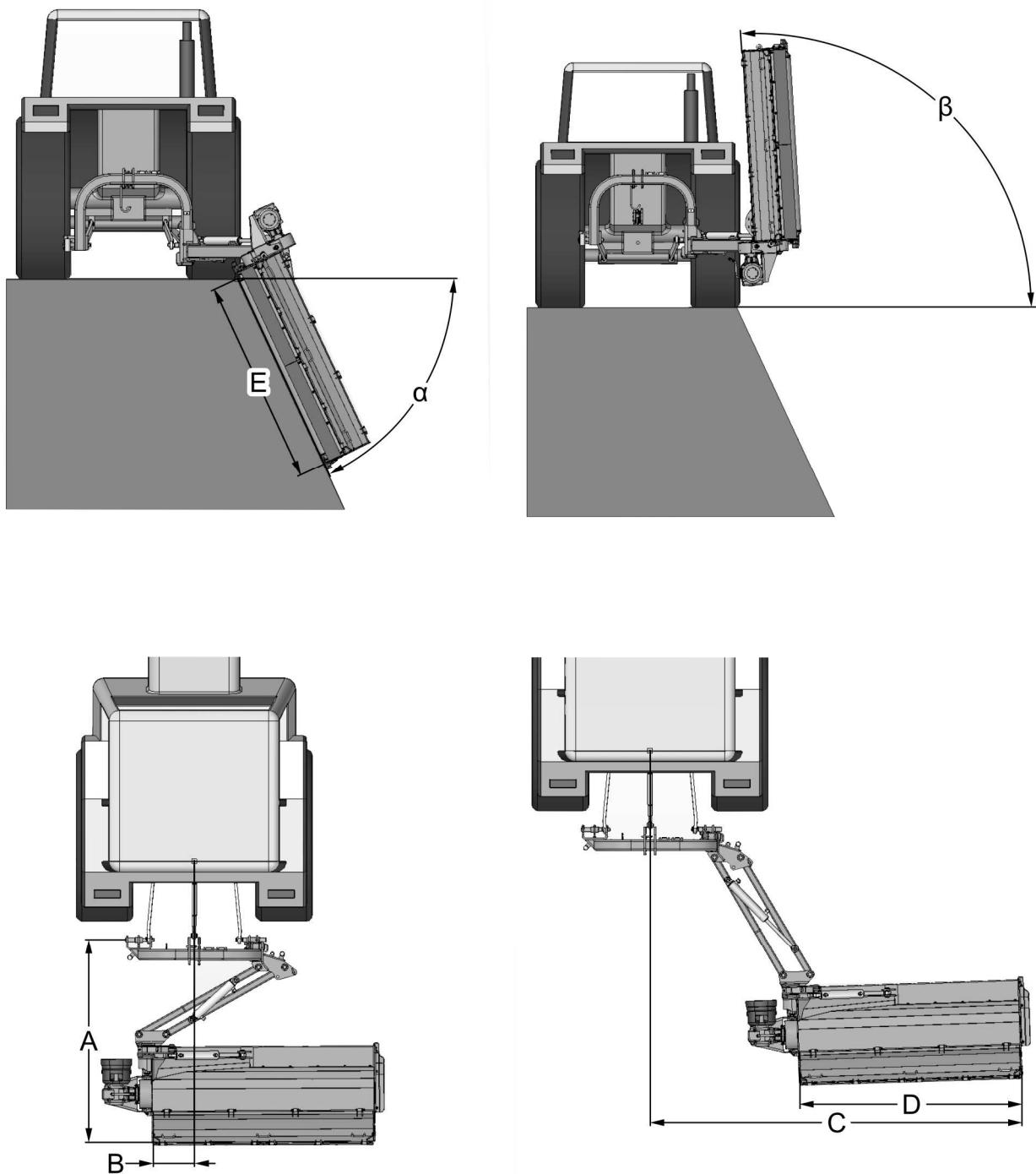
**РИСУНОК 3.1 Радиус захвата и рабочий угол косилки**
