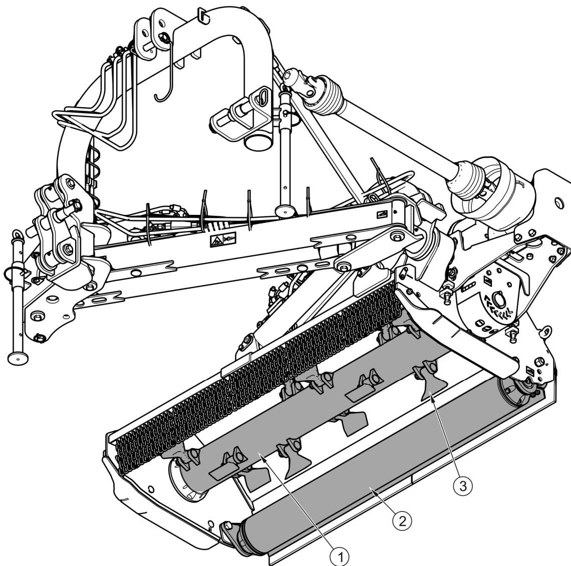
**РИСУНОК 3.6 Режущий аппарат**
