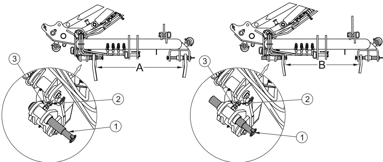
**РИСУНОК 4.3 Регулировка нижних сцепных шкворней навесной системы косилки**
