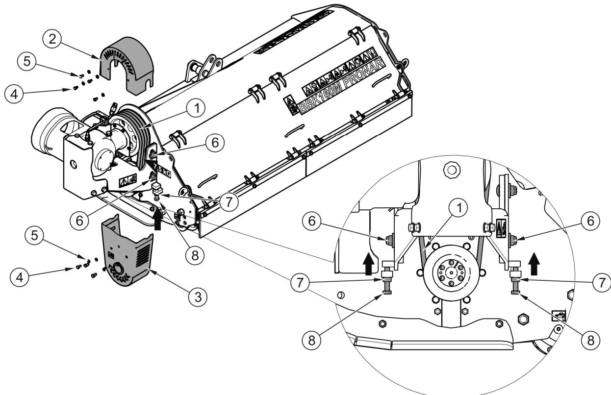
**РИСУНОК 5.4 КОНТРОЛЬ И РЕГУЛИРОВАНИЕ НАТЯЖЕНИЯ КЛИНОВЫХ РЕМНЕЙ**
