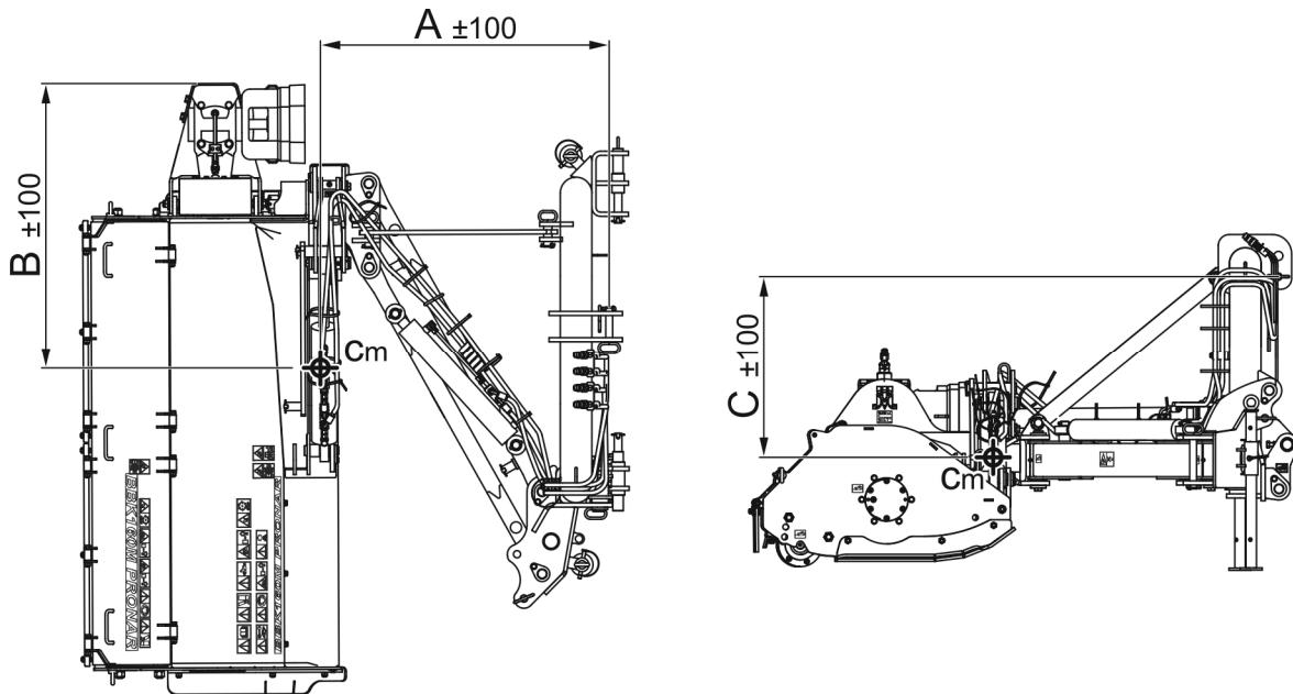
**РИСУНОК 1.4 Расположение центра тяжести косилки**
