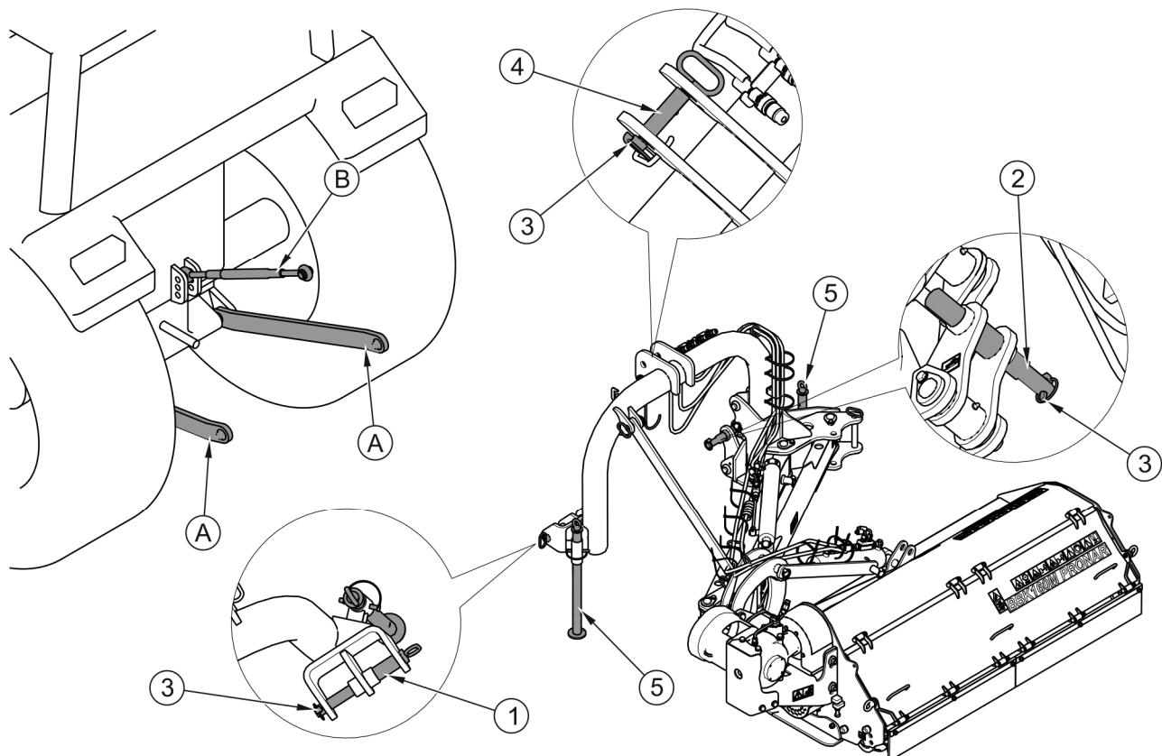
**РИСУНОК 4.2 Подсоединение к трактору**
