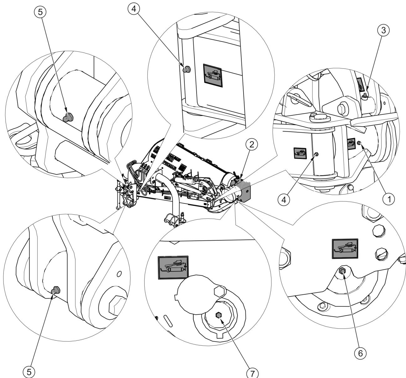
**РИСУНОК 5.7 ТОЧКИ СМАЗКИ (ВИД А)**
