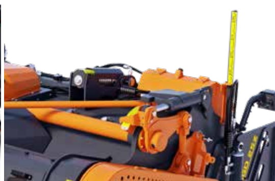
Mécanisme de levage de l'arbre permettant un volume variable de la chambre de mélange
