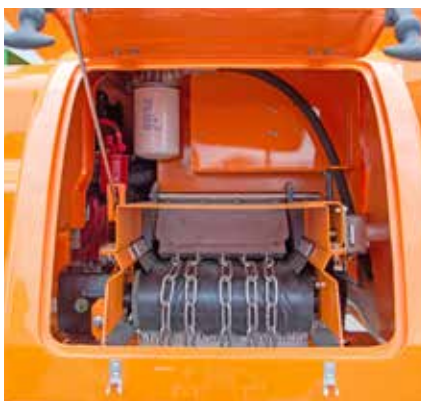
Le matériau est transporté par un convoyeur à bande vers le système de chargement
