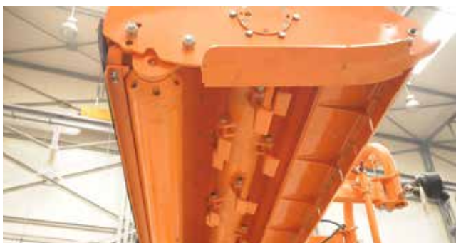
Arbre à fléaux avec des marteaux à fléaux
