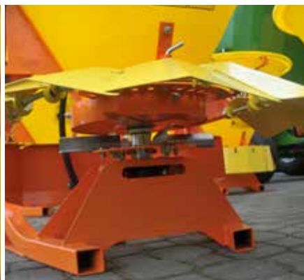
Plateau épandeur en acier inoxydable.
