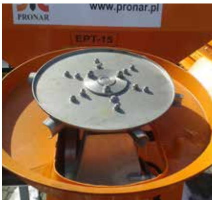
Disque d'épandage en acier inoxydable
