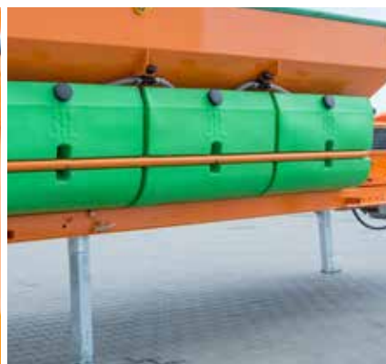
Pieds de support réglables en hauteur permettant le chargement de la machine sur une benne basculante sans l'utilisation de dispositifs supplémentaires (système RORO)
