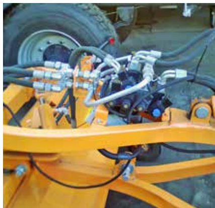
Rotation hydraulique des brosses \pm 30^\circ
