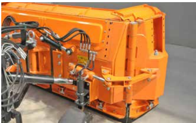
Réglage hydraulique de la position de l'aile de -60 degrés jusqu'à +90 degrés
