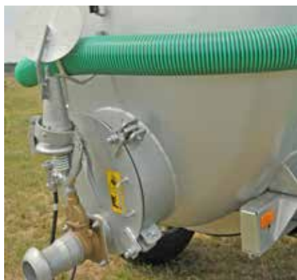
Raccord de vidange au point le plus bas de la tank
