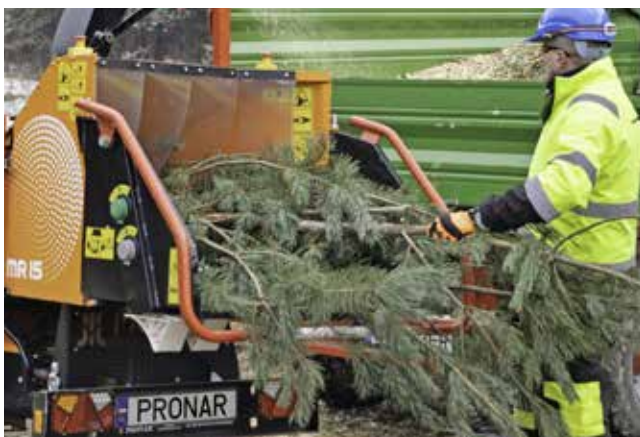
Rampe de chargement et barre de sécurité
