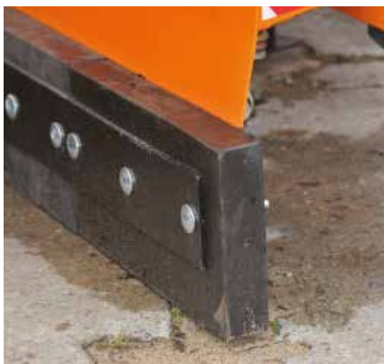
Lames en caoutchouc avec absorption des chocs
