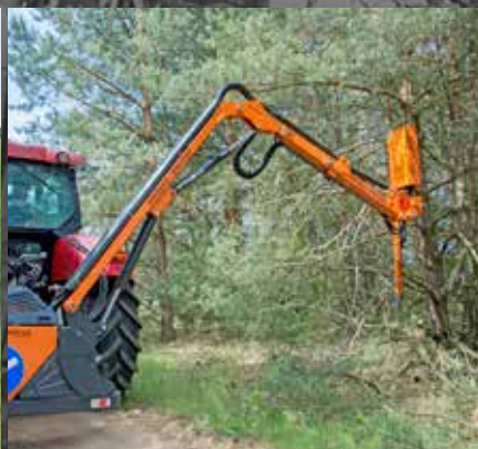
BRAS-SUPPORT MULTI-FONCTIONS WWT700T TÊTE DE COUPE GN200
