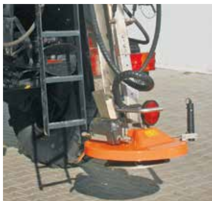
Hauteur ajustable de l'adaptateur d'épandage.
