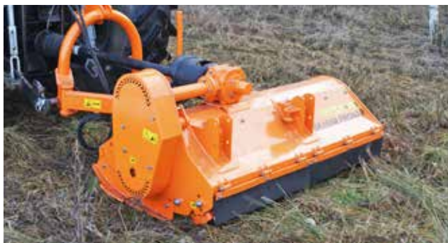
Engrenage angulaire et transmission par courroie – protection contre les surcharges des tondeuses de la série BK
