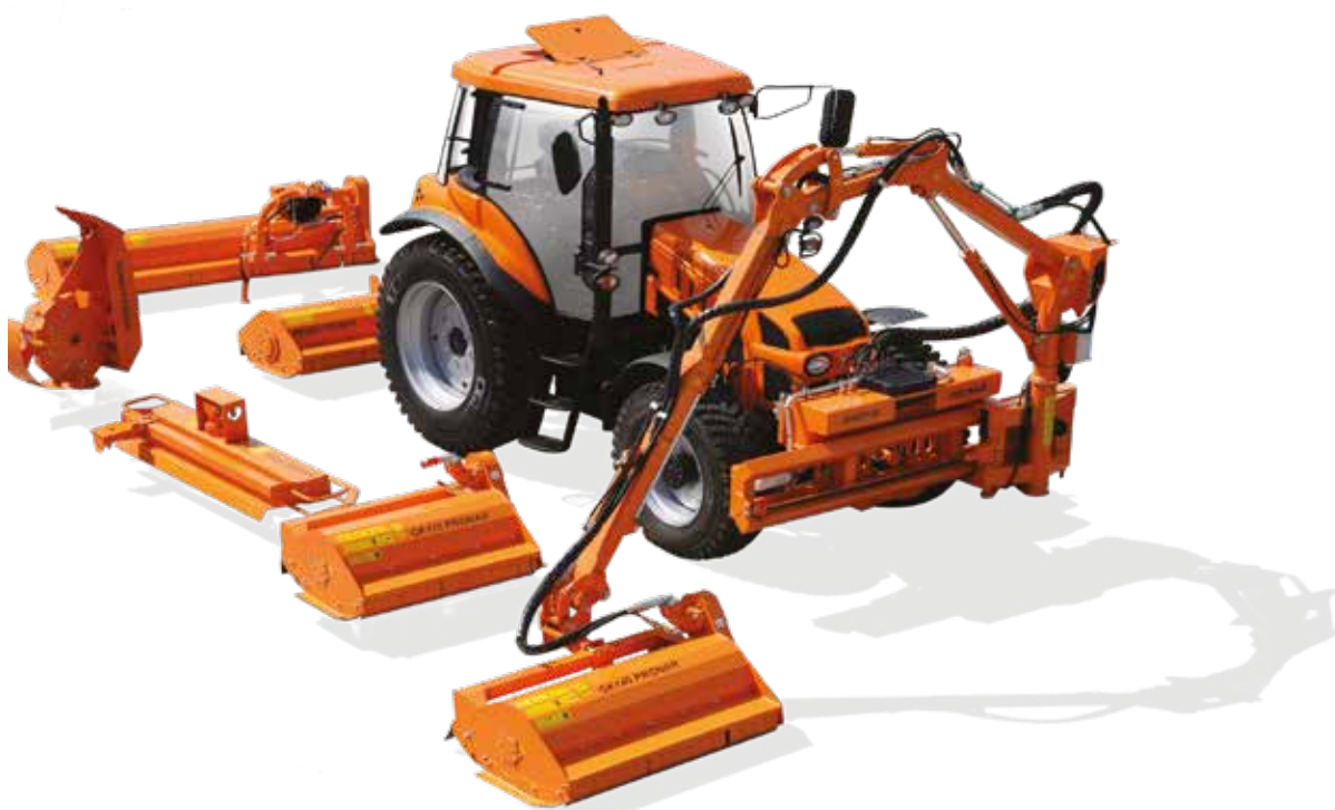
Bras-support WWP600 – bras de portée jusqu'à 7 m permet de travailler dans des lieux difficiles à atteindre : fossés, escarpes, fossés de drainage
