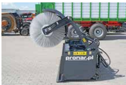
Angle d'élévation réalisé par deux vérins hydrauliques
