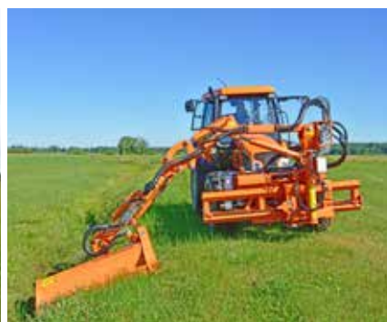
Bras-support WWP600 – décalage hydraulique du bras de service sur le guide
