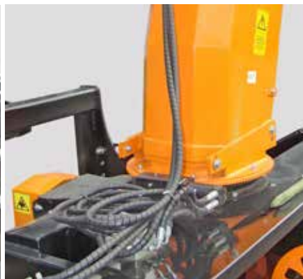
Rotation hydraulique de la cheminée et ajustement de la distance d'éjection
