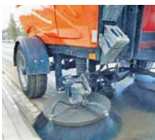
Système d'arrosage devant les balais à disques
