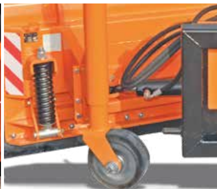
Roues d'appui en caoutchouc.
