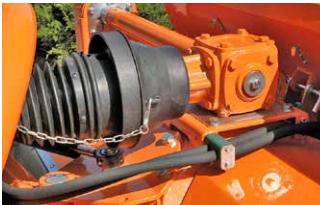
Propulsion mécanique de balai de PTO
