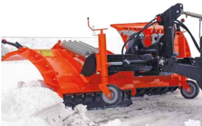
Versoir polygonal avec la protection par ressorts.
