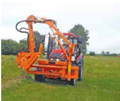
Bras-support WWP600 – bras de portée jusqu'à 7 m permet de travailler dans des lieux difficiles à atteindre : fossés, escarpes, fossés de drainage
