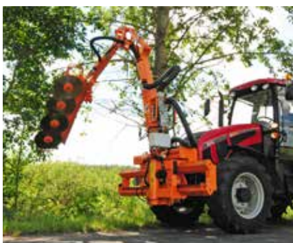
Bras-support WWP600 avec scie pour couper des branches GP200
