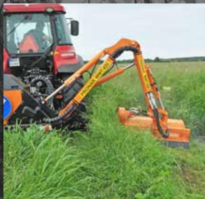
BRAS-SUPPORT MULTI-FONCTIONS WWT420 TÊTE DE COUPE GK80L
