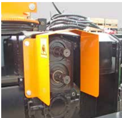
Transmission avec deux PDF extrêmes (540/1000 tr./min)
