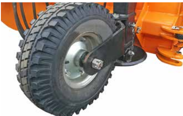
Les roues de support afin maintenir la distance entre la surface et les lames (pour réduire l'épaisseur de la couche enlevée)
