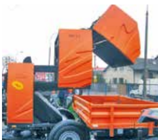
Système de vidange hydraulique
