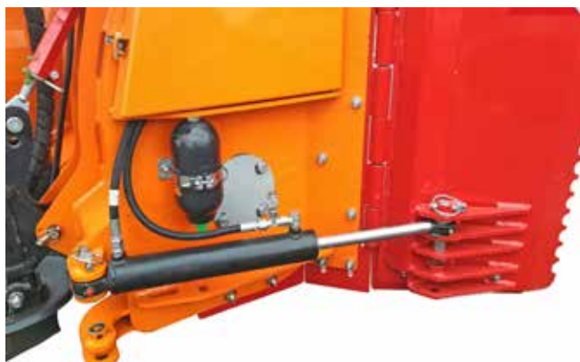
Contrôle hydraulique des élargissements
