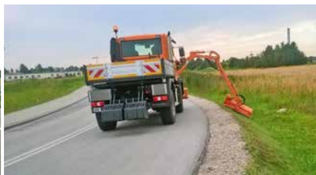
Bras-support WWP500U avec tête de fauchage GK110 sur Unimog U500
