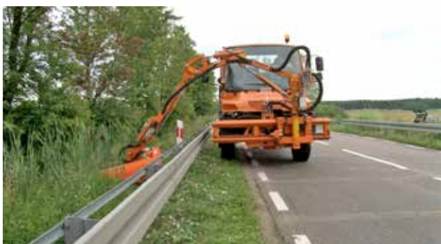
Fauchage de l'accotement difficilement accessible à l'aide de la tête WWP500U et la tête GK 110
