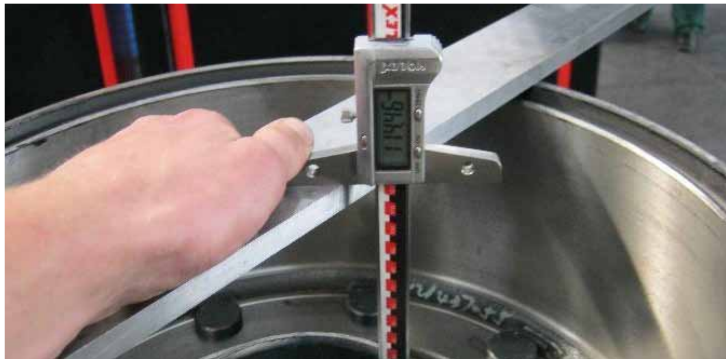
Beispielsweise Messungen bei der Kontrolle von Trommelnaben. Links: Messung der Entfernung zwischen dem Ende der Trommel und dem Anfang der Nabe ( 181 \pm 1 mm) mit Hilfe des Höhenmessers; rechts: Messung der Position der Rollbahn für das Lager ( 114 \pm 1 mm) mit Hilfe des Tiefenmessers
