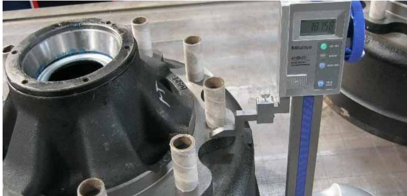
Beispielsweise Messungen bei der Kontrolle von Trommelnaben. Links: Messung der Entfernung zwischen dem Ende der Trommel und dem Anfang der Nabe ( 181 \pm 1 mm) mit Hilfe des Höhenmessers; rechts: Messung der Position der Rollbahn für das Lager ( 114 \pm 1 mm) mit Hilfe des Tiefenmessers
