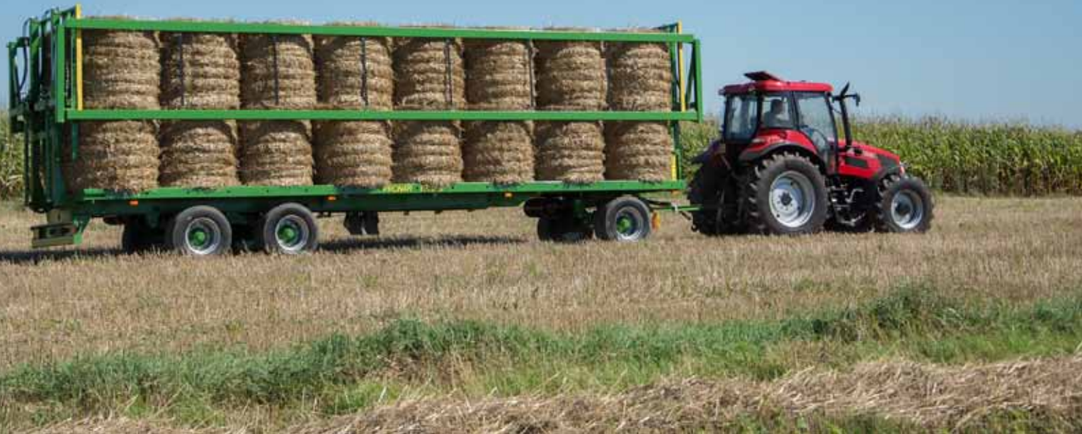
Hydraulisches Ladungssicherungssystem bei Ballenanhängern
