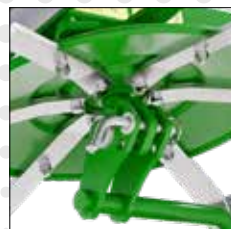
• 3 stopnie regulacji kąta rozrzutu
