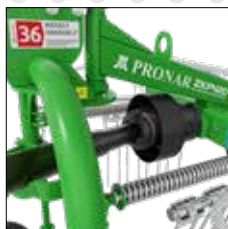
• zawieszenie aktywne ze stabilizatorami amortyzującymi (opcja)
