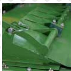
5-stopniowa regulacja siły spalchniania pokosu (PDF301C)
