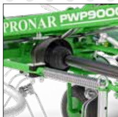
• amortyzator sprężynowy, stabilizujący maszynę
