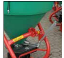
• dźwignia regulacji dawki i kierunku wysiewu
