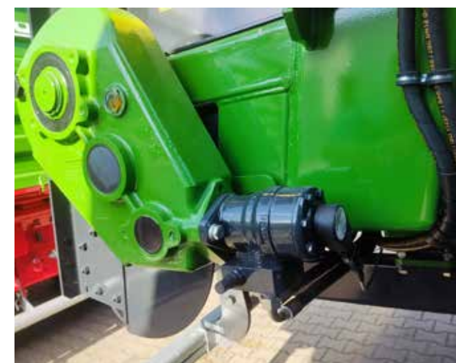
▲ Enkoder zamontowany na silniku hydraulicznym przekazuje do sterownika informacje o prędkości przesuwu przenośnika podłogowego
