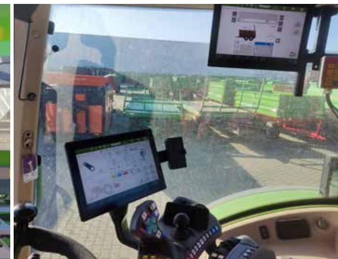
▲ Komunikacja z ciągnikiem wyposażonym w Isobus
