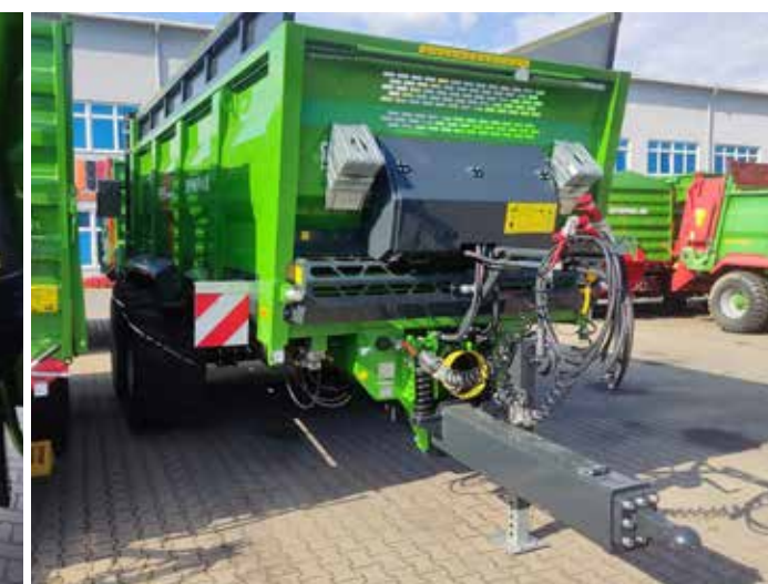
▲ Instalacja elektrohydrauliczna systemu Isobus jest zabezpieczona uchylną osłoną
