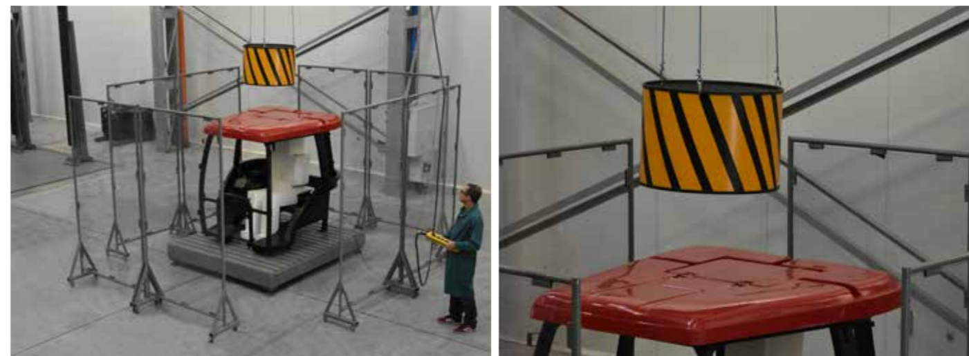
Stanowisko pozwala na prowadzenie badań dynamicznych konstrukcji ochronnych (FOPS - (ang. falling-object protective structure). Badania tego typu mogą mieć zastosowanie np.: w ciągnikach leśnych, maszynach budowlanych, wózkach widłowych
