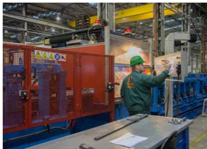
Operator linii produkcyjnej modyfikuje parametry spawania w zależności od grubości i kształtu profilu
