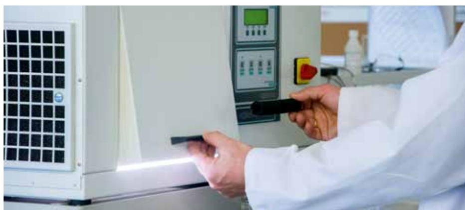
Komora UV pozwala na symulację zmieniających się warunków pogodowych m.in. temperatury, promieniowania UV i wilgotności
