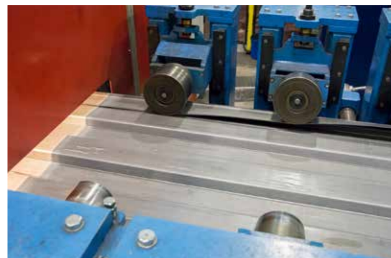
Ukształtowany profil burtowy jest wprowadzany do modułu spawającego laserem
