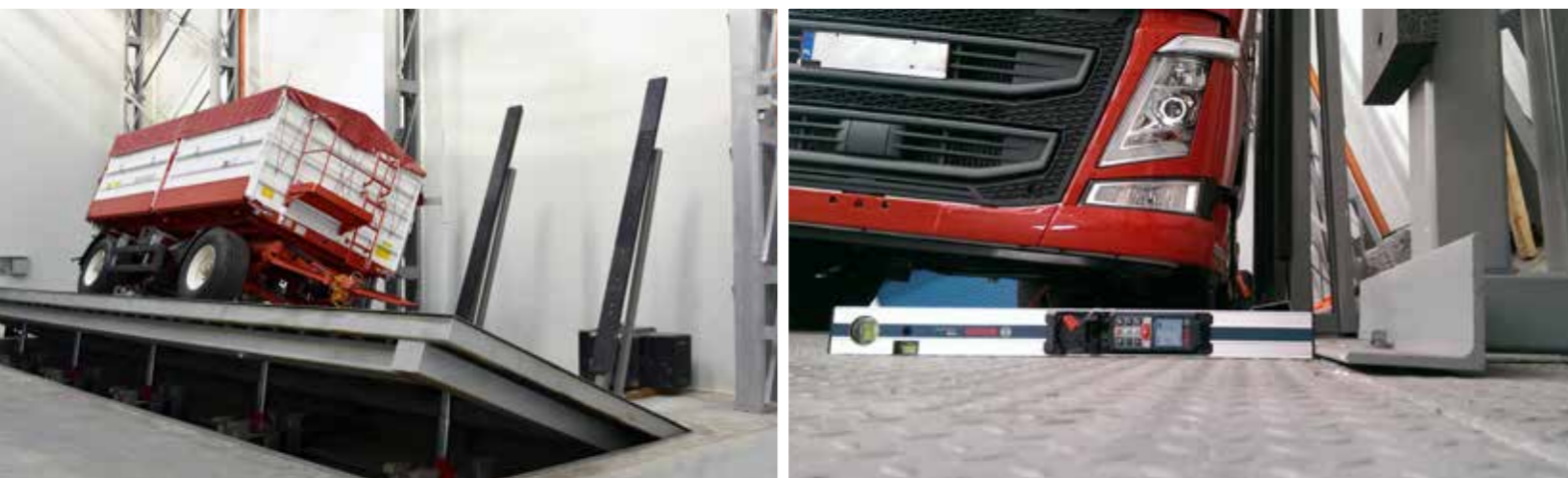
Stanowisko pozwala na zweryfikowanie teoretycznych założeń i obliczeń dotyczących minimalnej stateczności maszyn, w tym z linii do zbioru masy zielonej z terenów podmokłych.
