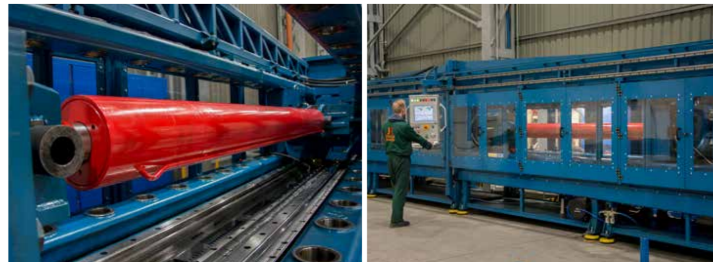
Stanowisko badawcze umożliwia badanie w warunkach laboratoryjnych siłowników hydraulicznych jednostronnego i dwustronnego działania, stanowiących element budowy maszyn
