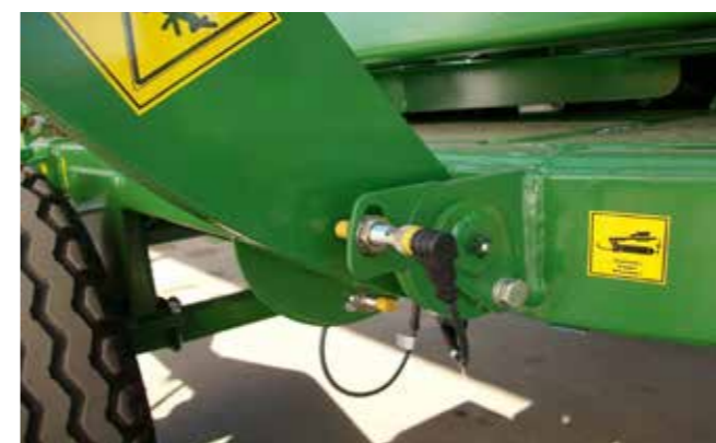
Prawidłowe działanie maszyny wymaga przesmarowania wszystkich smarowniczek i sprawdzenia działania czujników
