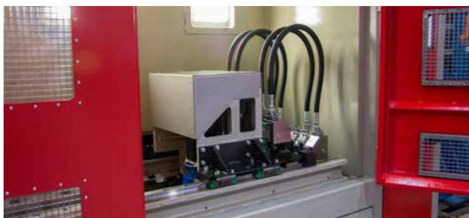
Stanoisko badawcze pozwala na przebadanie przewodów i złączy hydraulicznych w warunkach eksploatacyjnych (warunkach pracy) bez konieczności montowania ich w wyrobie docelowym
