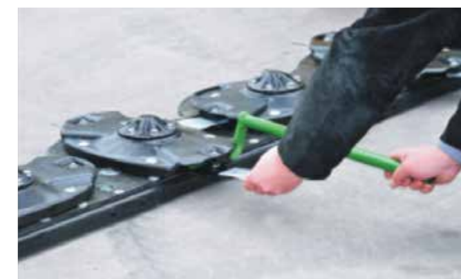
Uszkodzone noże tnące należy wymienić na nowe
