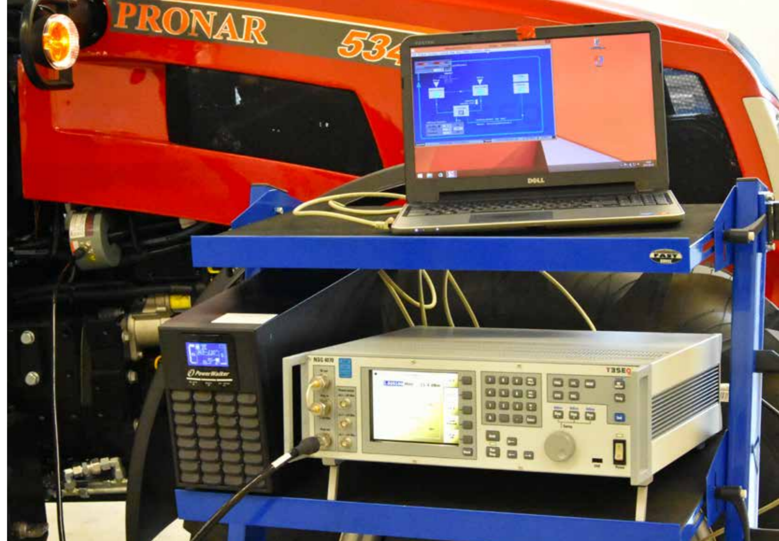
Zestaw urządzeń pomiarowych do badań odporności na zakłócenia elektromagnetyczne
