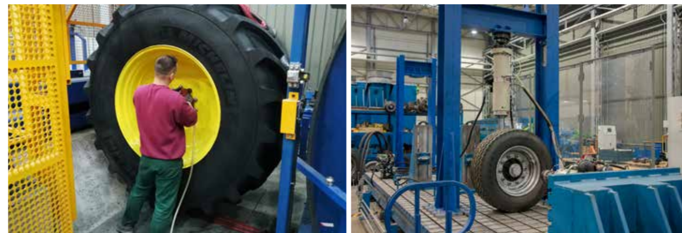
Urządzenie pozwala na wykonanie badań trwałości opon i „badań wytrzymałości zmęczeniowej kół” do prędkości 120km/h i kół ze wzmocnionym obrzeżem i z pierścieniem wykonanym w technologii obróbki plastycznej
