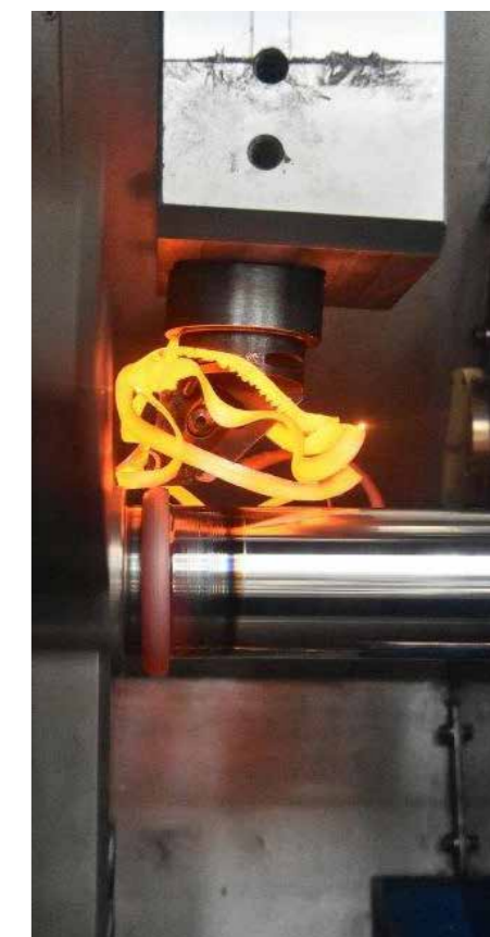
Zgrzewarka tarcowa umożliwia trwałe łączenie elementów w wyniku tarcia powierzchni ich styku
