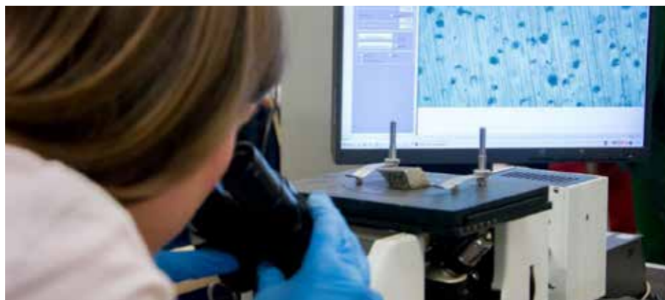
Stanoisko do badań metalograficznych umożliwia badania mikrostruktury metali i ich stopów, m.in. analizę wielkości ziarna, wtrąceń, porowatości, pęknięć oraz innych wad materiałowych
