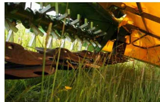
Przygotowanie maszyny do pracy wymaga m.in. sprawdzenia noży tnących i elementów roboczych spulchniacza pokosów
