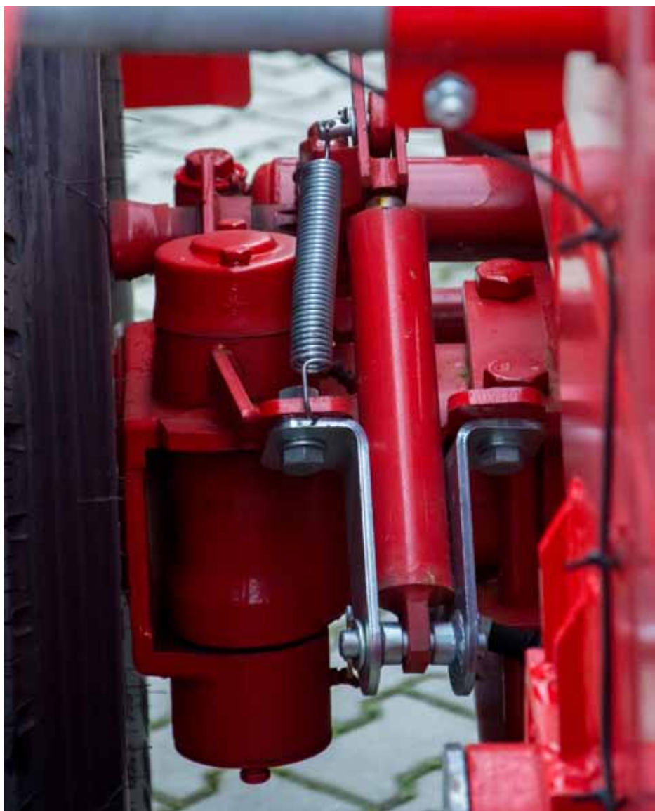
Cylinder nurnikowy hydraulicznego układu hamulcowego zamontowany na osi skrętnej
