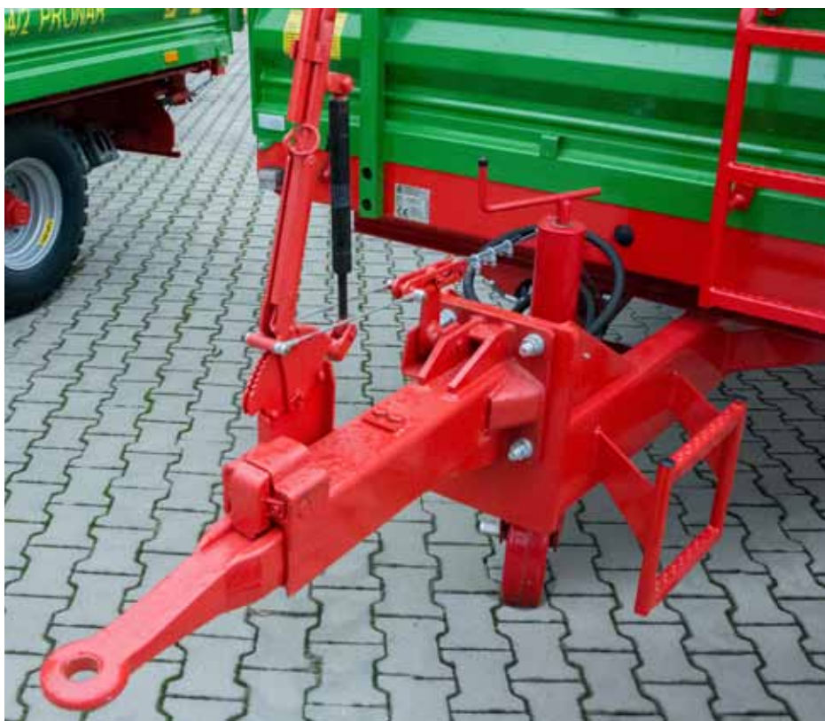
Dyszle z mechanizmem hamulca najazdowego zamontowany na przyczepie jednoosiowej
