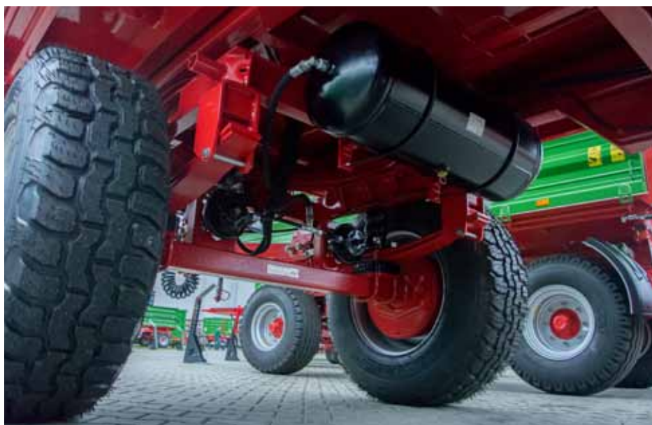
Pneumatyczny układ hamulcowy zamontowany na przyczepie dwuosiowej
