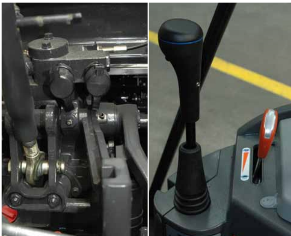
Centralnie położony rozdzielacz oraz pojedynczy joystick do sterowania ładowaczem czołowym stanowi standardowe wyposażenie w ciągniku NX4510
