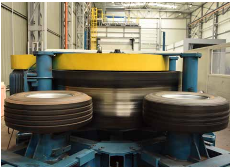
Urządzenie do badania wytrzymałości zmęczeniowej na zginanie tarczy (Pronar dysponuje możliwościami jednoczesnego badania dwóch kół)
