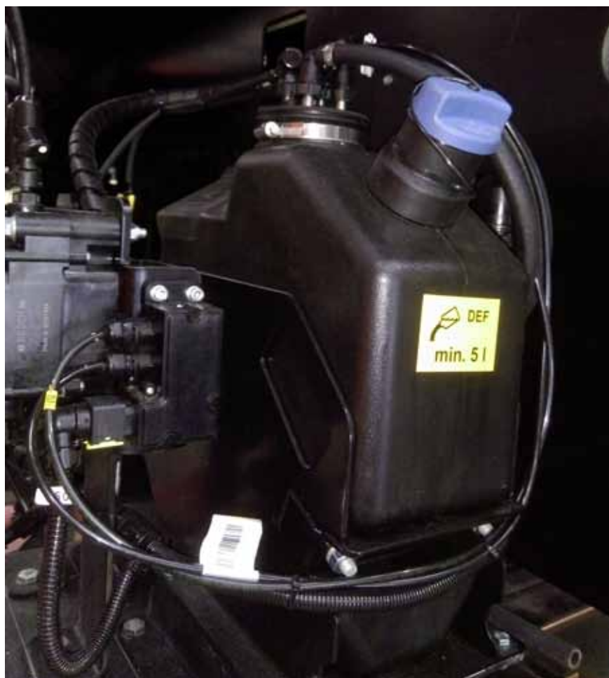
Zbiornik i pompę płynu AdBlue umieszczono za przednią osłoną w łatwo dostępnym miejscu.
