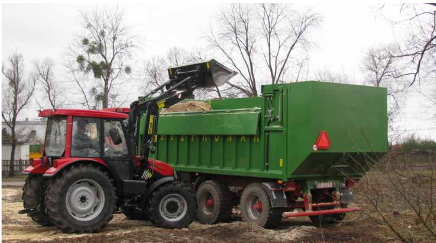
Hydraulicznie sterowana kłapa boczna umożliwia załadunek maszynom o niższym zasięgu
