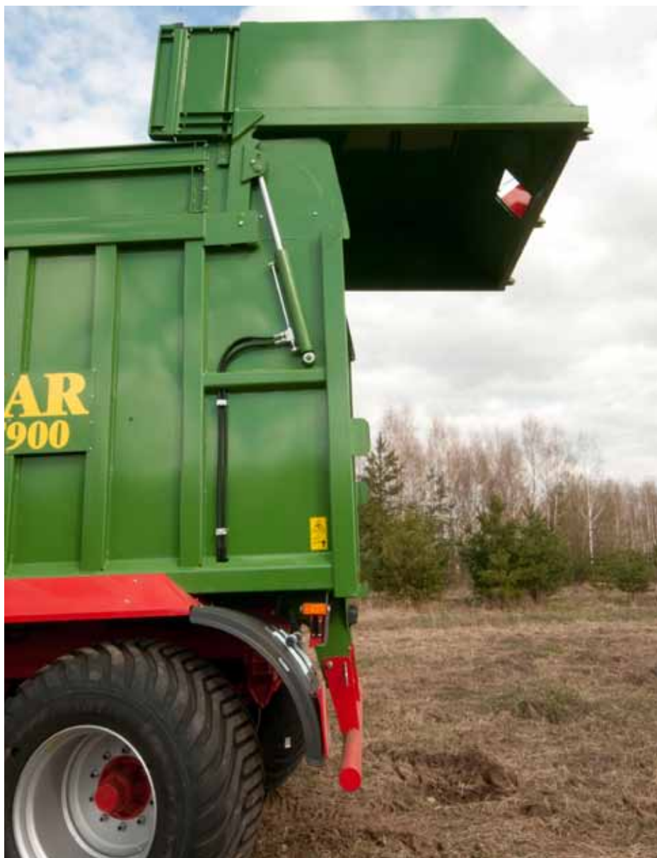
Nisko otwierająca się kłapa tylna w PRONAR T900
