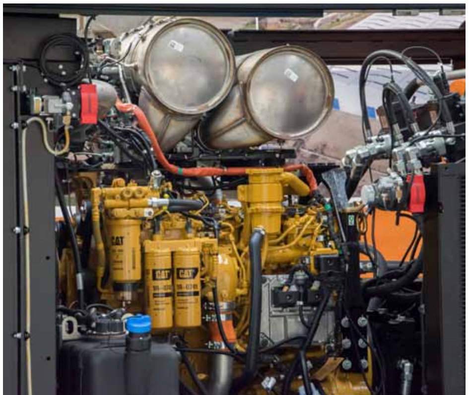
Nowoczesna jednostka napędowa CAT, spełniająca normy emisji spalin Stage 4
