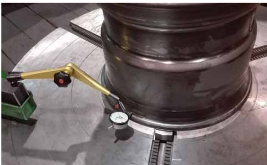
W kolejnym etapie koła sprawdzane są zgodnie z obowiązującą instrukcją kontroli wyrobów na WKT. W cyklu automatycznym odbywa się również obróbka mechaniczna krawędzi koła
