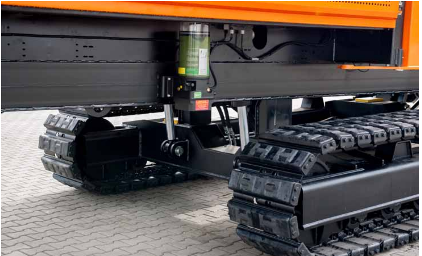
Możliwość uniesienia przodu i/lub tyłu maszyny ułatwia załadunek na przyczepę niskopodwoziową i poruszanie się w trudnym terenie
