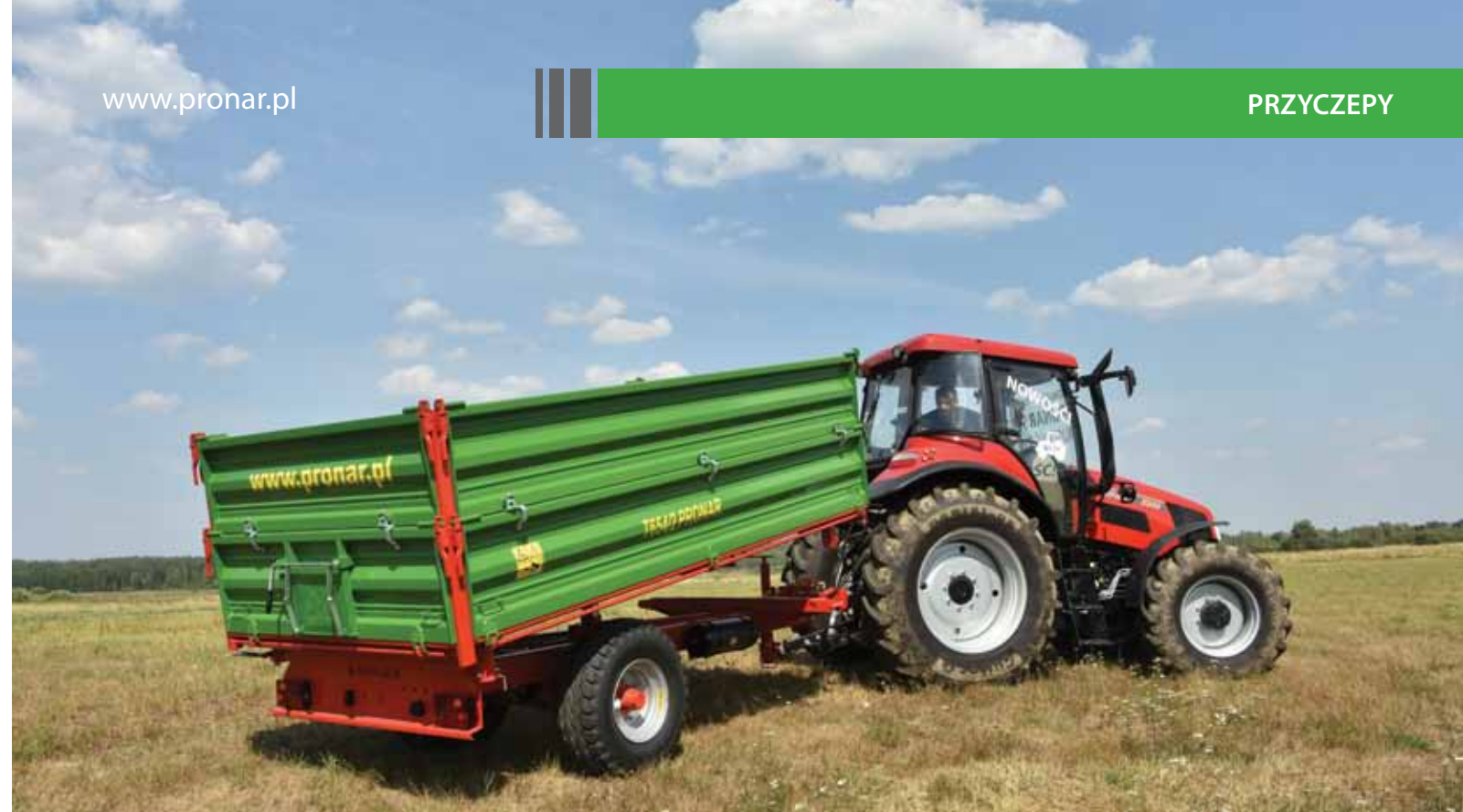
Pomimo niewielkich rozmiarów, przyczepy jednoosiowe Pronaru są standardowo wyposażone w trójstronny wywrót
