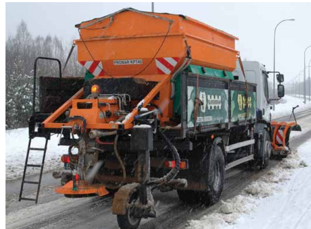
Koło wleczone jest sprawdzoną opcją zasilania układu hydraulicznego posypywarek PRONAR PT40, która znakomicie spisyuje się przy współpracy z nośnikiem bez hydrauliki
