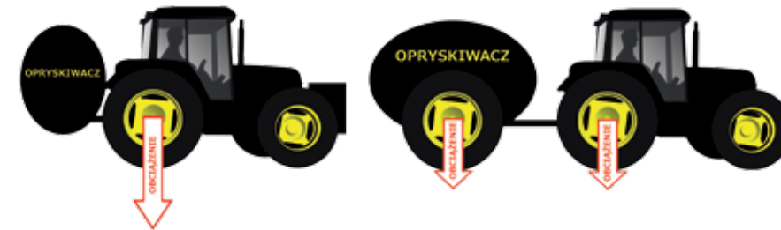
Rozkład obciążeń w zależności od stosowanego osprzętu
