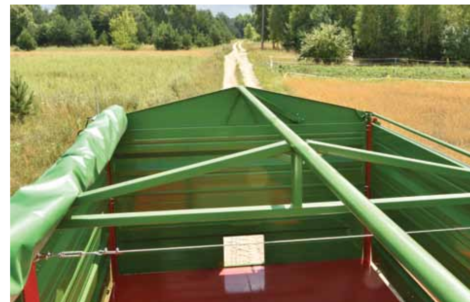
System montażu i rolowania planeki pozwala zabezpieczyć ładunek przed niekorzystnym wpływem warunków atmosferycznych
