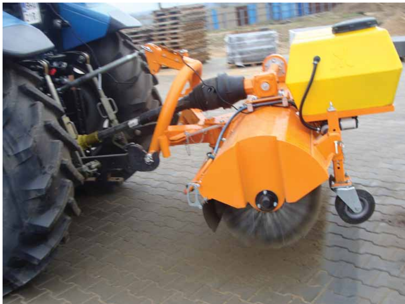
ZM-P16 w konfiguracji do letniego zamiatania z układem zraszania
