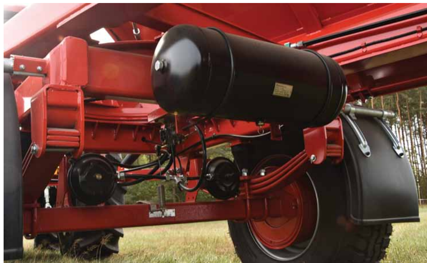
Solidne osie zawieszone są na trwałych resorach parabolicznych
