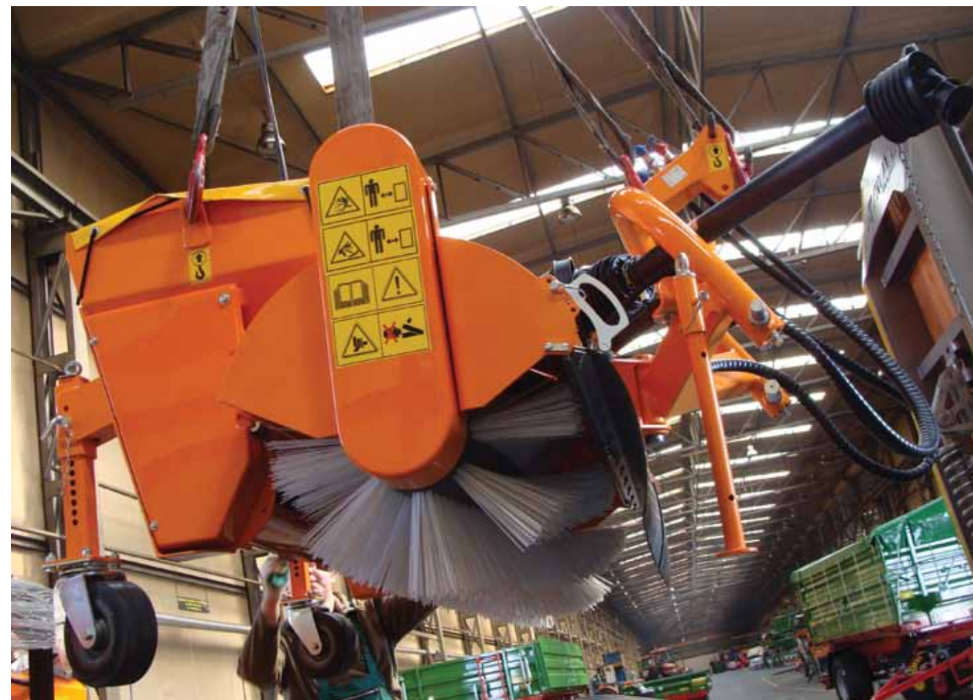
Specjalne, przereźdzone włosie do zimowego zamiatania ZM-P16 zapobiega przed zalepianiem szczotki podczas odmiatania śniegu
