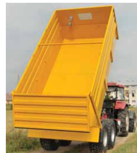
Tylna kłapa otwierana hydraulicznie do dołu zapobiega wysypywaniu zawartości pod przyczepę
