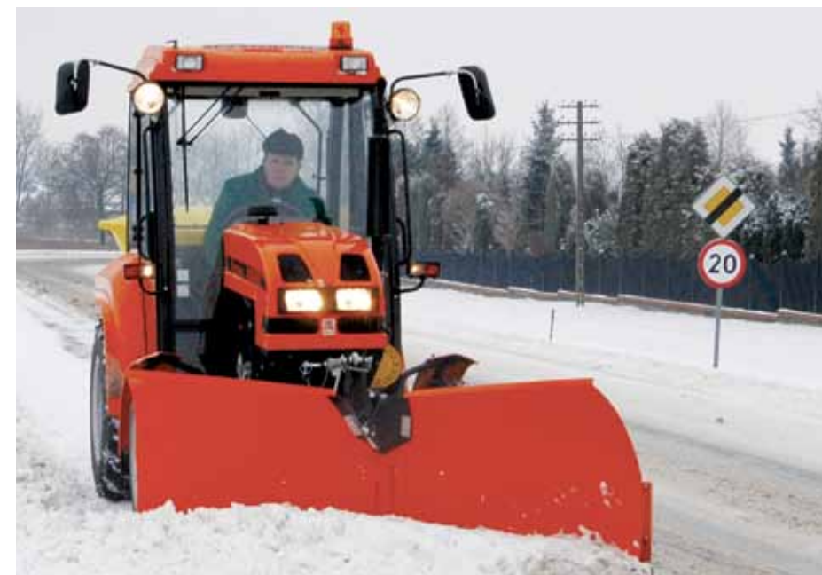
Dzięki kompaktowym rozmiarom i możliwości niezależnego ustawiania odkładnic, małe pługi serii PUV-M znakomicie spisują się przy utrzymaniu miejskich dróg osiedlowych
