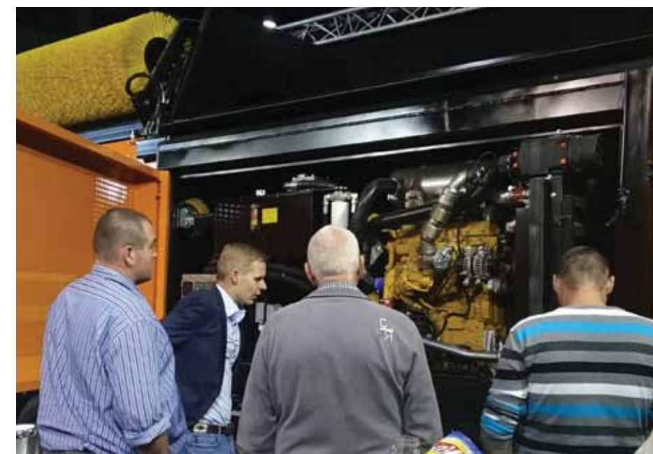
Łatwy dostęp do komory silnika zapewnia otwieranie bocznej osłony do kąta 90°
