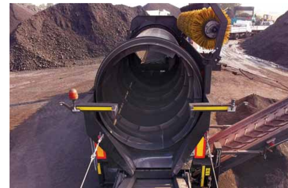
Wreگی w bębnie transportują wsad w kierunku wylotu, zapewniając długi czas przebywania przesiewanego materiału wewnątrz, co daje wysoką efektywność separacji frakcji
