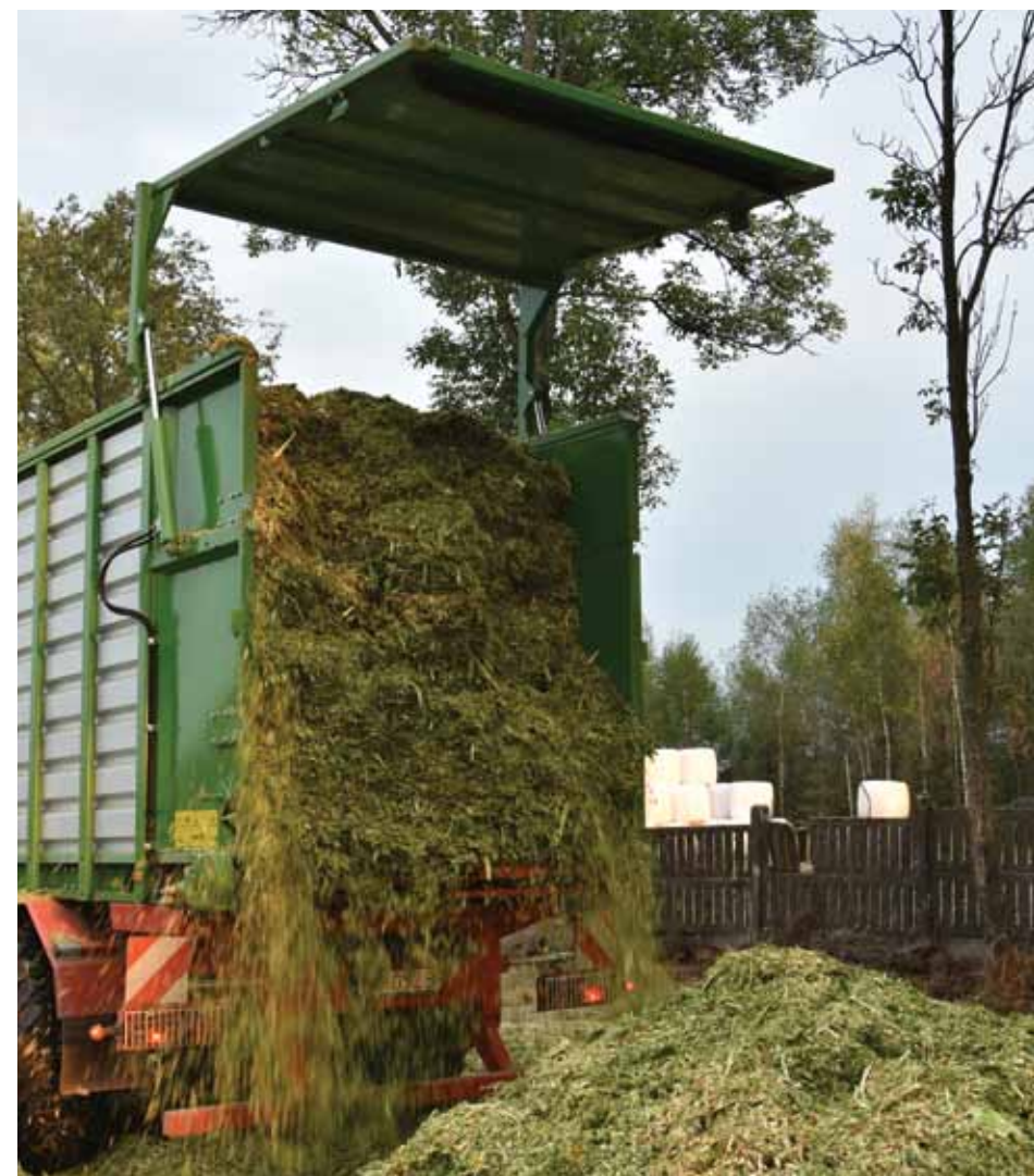
Hydraulicznie unoszona tylna ściana przyczepy do biomasy PRONAR T400 sprawdza się przy rozładunku także tam, gdzie nie ma możliwości wykiprowania standardową przyczepą
