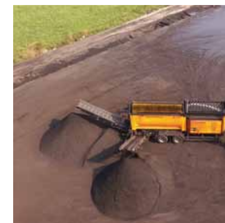
Wreگی w bębnie transportują wsad w kierunku wylotu, zapewniając długi czas przebywania przesiewanego materiału wewnątrz, co daje wysoką efektywność separacji frakcji
