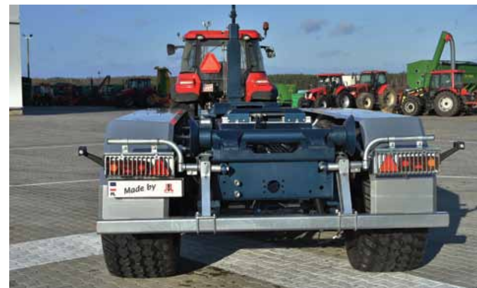
Hydraulicznie wysuwana tylna belka, tylne gniazda hydrauliki i możliwość doposażenia przyczepy w zaczep transportowy - to znaki rozpoznawcze przyczepy T386
