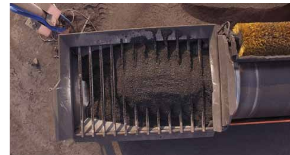
Krata kosza zasypowego chroni maszynę przed dostaniem się niepożądanych materiałów do bębna, zabezpieczając przesiewacz przed uszkodzeniem
