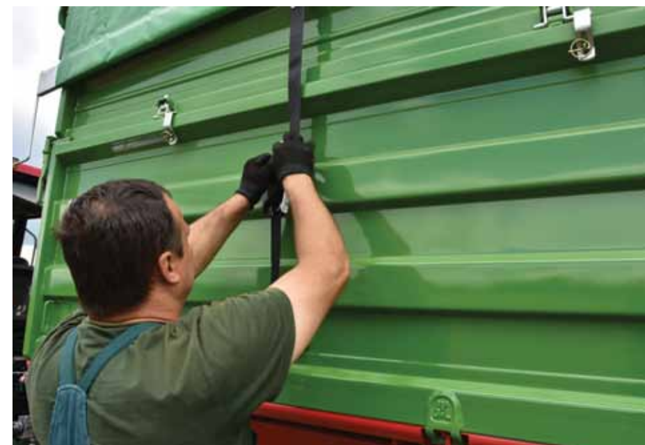
System montażu i rolowania planeki pozwala zabezpieczyć ładunek przed niekorzystnym wpływem warunków atmosferycznych
